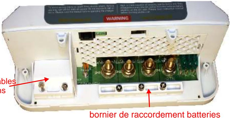
Enlever les deux vis du cache se trouvant sur les câbles de courant alternatif et les trois vis se trouvant sous les borniers de raccordement aux batteries. Ceci permettra de câbler le système. Assurez vous d'utiliser des cosses rondes adaptées et d'utiliser des pinces à sertir pour que le câble soit correctement installé.
