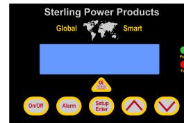
FB Bedienung.Wenn Sie die FB neu installieren beachten Sie folgendes: wenn das Ladegerät an ist und sie verbinden die FB wird sie nicht funktionieren. Nach dem Anschließen stellen Sie das Ladegerät für 1min ab um die Software zurückzustellen. Wenn Sie wieder einschalten wird die FB gefunden und sollte dann funktionieren.
