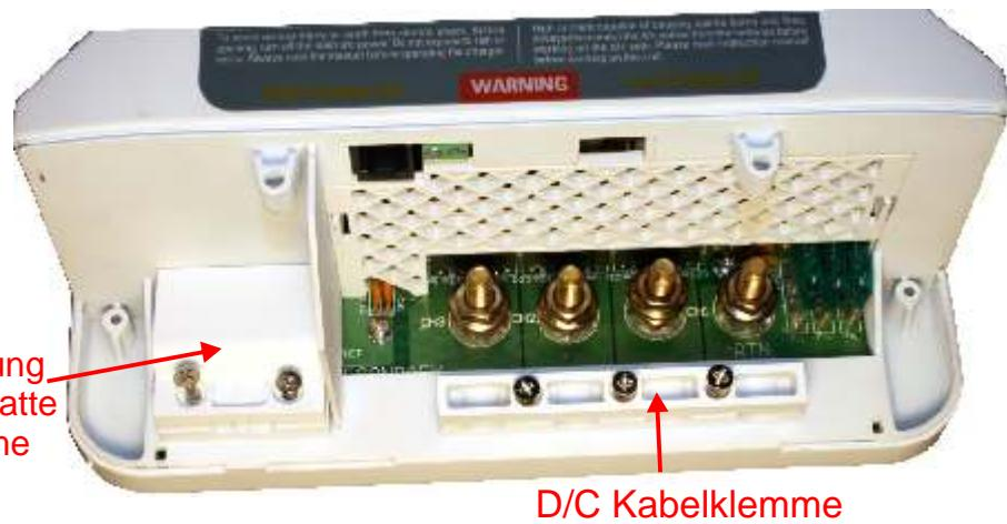
Entfernen Sie die beiden Schrauben im A/C Bereich und die 3 Schrauben bei der D/C Klemme um die passenden Kabel anzuschließen
